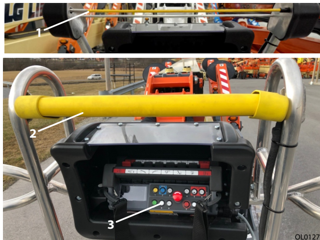
Figur 4-7. Placering af SkyGuard™ Sensor og tilsidesættelseskontakt
