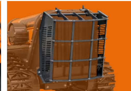
Protezione radiatore in acciaio Steel radiator protection
